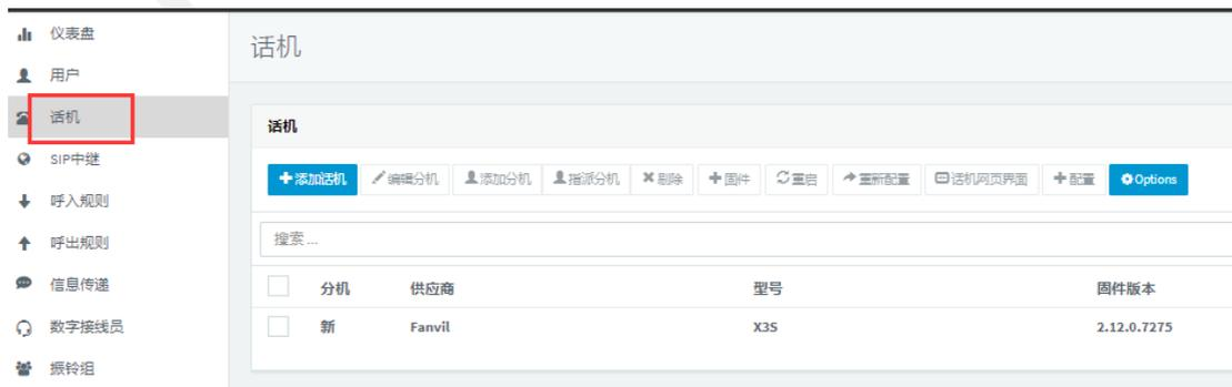
2、选择要配置的话机，然后可以选择“添加分机”创建一个新的分机并配置 IP 话机或者选择“指派分机”将此 IP 话机指派到需要配置的分机。
